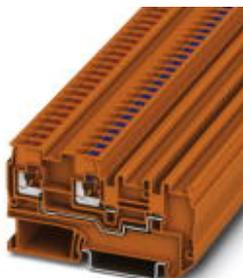
Bloc de jonction pour capteurs / actionneurs, Mode de raccordement: Raccordement Push-in, section :0,2 mm<sup>2</sup> - 4 mm<sup>2</sup>, AWG: 24 - 12, Largeur: 7 mm, Coloris: orange, Type de montage: NS 35/7,5, NS 35/15
