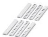
Repérage ZB, plat, Rubans, blanc, vierge, repérable avec : Traceur, Type de montage: Encliquetage dans la rainure de repérage plate, pour bloc de jonction au pas de : 5 mm, Surface utile: 5,1 x 5,2 mm
