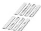
Repérage ZB, plat, Rubans, blanc, repéré, impression longitudinale: numérotation continue 1-10, 11-20, etc. jusqu'à 491-500, Type de montage: Encliquetage dans la rainure de repérage plate, pour bloc de jonction au pas de : 5 mm, Surface utile: 5,15 x 5,15 mm
