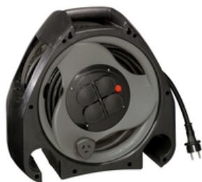
Enrouleur professionnel (grande capacité) 4 prises 2 P + T avec sécurité et volet - 10/16 A - 250 V - IP 44 - câble noir de 50 m (H 07 RNF 3 x 1,5 mm<sup>2</sup>)
