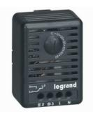
Thermostat d'ambiance - réglable de 5 à 60 °C - pour coffrets et armoires contact à l'ouverture 10 A - contact à la fermeture 5 A - fixation sur rail symmétrique
