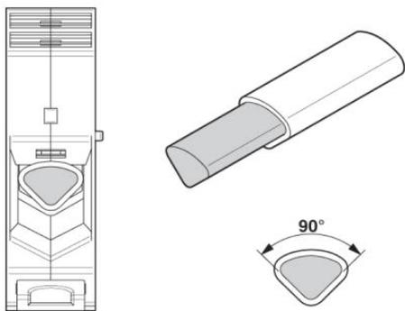
Raccordement de conducteurs en aluminium. Remarques supplémentaires dans la zone de téléchargement
