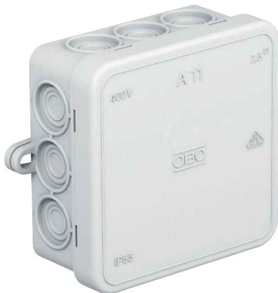
Type de protection IP55, tension nominale 400 V, section nominale 2,5 + mm<sup>2</sup>, 12 entrées pour diamètres de câble de 5 à 14 mm.
