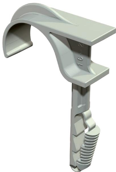
Les brides enfichables sont destinés à la pose de câbles et de tubes sur les murs et plafonds ainsi qu'à la pose de tubes flexibles sur les supports en béton et en plâtre. Les brides enfichables simples remplacent les clips de fixation à clou dans le béton et le béton cellulaire. L'avantage des brides enfichables est qu'ils doivent simplement être emboîtés dans le trou de montage. L'utilisation de chevilles et de vis devient alors inutile.
