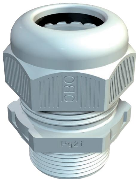
Le moyen le plus rapide et le plus pratique de fournir une décharge de traction et une étanchéité avec des presse-étoupes sur les boîtes de jonction et les boîtiers: les presse-étoupes V-TEC VM éprouvés d'OBO. Grâce au joint d'étanchéité intégré et à la technique spéciale de lamelles OBO, l'indice de protection IP68 est atteint. La décharge de traction et l'étanchéité sont contrôlées selon la norme DIN EN 62444
