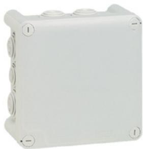
Boîte de dérivation carrée Plexo IP 55 - étanche - avec couvercle fermeture par 1/4 de tour - gris RAL 7035 - 10 embouts - dimensions 130 x 130 x 74 mm
