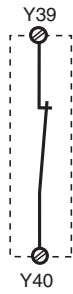
Fig. 8: Contacto normalmente cerrados para reseteo del tiempo de retardo/Contatto di riposo per il ripristino del tempo di ritardo/ Verbreekcontact voor het resetten van de vertragingstijd
