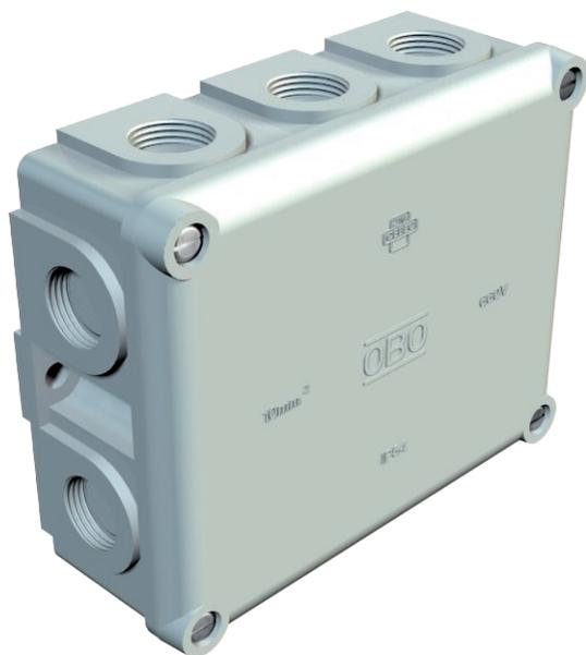
Indice de protection IP54, tension nominale 660 V, section nominale 10 mm<sup>2</sup>, 2 trous de fixation pour vis jusqu'à 6 mm de Ø sur la face extérieure du boîtier, 4 vis pour couvercle, 10 entrées défonçables avec filetage M20 x 1,5, de préférence pour presse-étoupes à filetage court. Dimensions intérieures: 125x100x44 mm.
