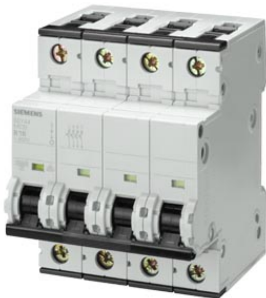
DISJONCTEUR DE LIGNE 400V 6KA, 4POLAIRE, C, 20A, P=70MM
