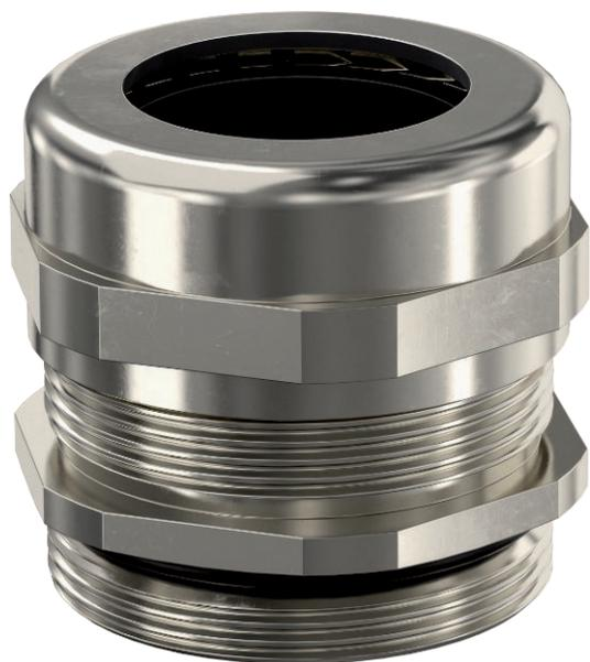
Presse-étoupe robuste de type écrou borgne avec filetage métrique selon la norme CEI 423, pour des exigences d'étanchéité élevées. Décharge de traction, protection antitorsion et étanchéité pour l'ensemble de la plage de serrage. Bague d'étanchéité en néoprène. Insert de serrage en polyamide. Avec bague d'étanchéité prémontée sur le filetage de raccordement, testée VDE selon DIN EN 50262, classe de protection IP68 à 5 bar / 1h, plage de températures d'utilisation -20 - 100°C.
