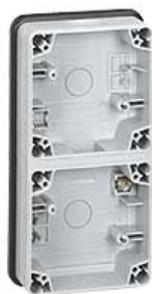
**Plexo 66 composable boîtier 2 postes verticaux - gris - IP 66 - IK 08 - livré avec bouchon d'étanchéité - livré avec presse-étoupe M 20 (ISO)**
