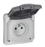
Plexo 66 composable prise 2P + T avec volet et avec sécurité - 10/16 A - 250 V - IP 66 - IK 08 - gris - reçoit les fiches 10/16 A droites ou coudées
