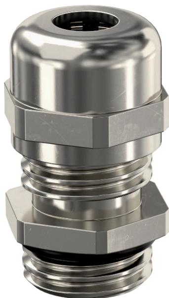
Presse-étoupe robuste de type écrou borgne avec filetage métrique selon la norme CEI 423, pour des exigences d'étanchéité élevées. Décharge de traction, protection antitorsion et étanchéité pour l'ensemble de la plage de serrage. Bague d'étanchéité en néoprène. Insert de serrage en polyamide. Avec bague d'étanchéité prémontée sur le filetage de raccordement, testée VDE selon DIN EN 50262, classe de protection IP68 à 5 bar / 1h, plage de températures d'utilisation -20 - 100°C.
