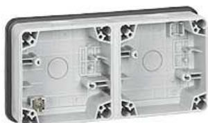
**Plexo 66 composable boîtier 2 postes horizontaux - gris - IP 66 - IK 08 - livré avec bouchon d'étanchéité - livré avec presse-étoupe M 20 (ISO)**
