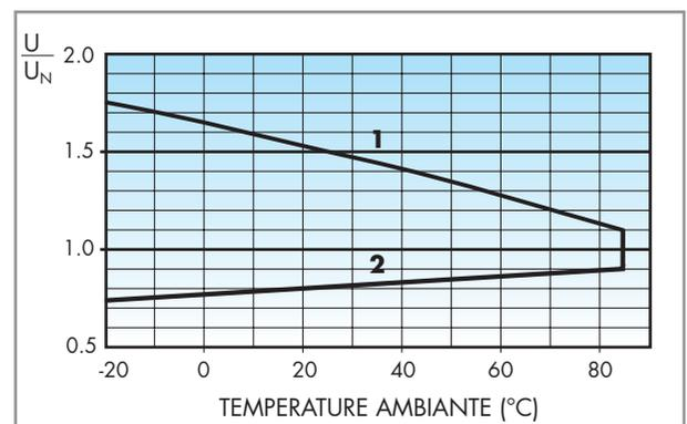
Plage de fonctionnement bobine en fonction de la température ambiante.
