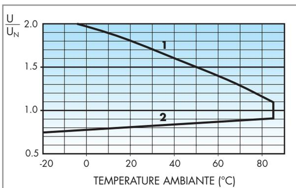
Plage de fonctionnement bobine en fonction de la température ambiante.
