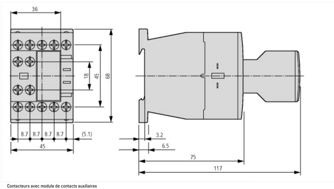
Contacteurs avec module de contacts auxiliaires
