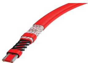
Les câbles chauffants de traçage électrique autorégulants nVent RAYCHEM XTV assurent la mise hors gel des conduits et des cuves qui nécessitent un nettoyage à la vapeur et le maintien de la température de process, jusqu'à 250-°F/121-°C. Ils résistent à une exposition intermittente pouvant atteindre 482-°F/250-°C. La gaine extérieure en polymère fluoré (-CT) offre une résistance chimique élevée contre les agents organiques et produits corrosifs.
