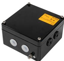
Le modèle JBU-100 nVent RAYCHEM est une boîte d'accouplement modulaire conçue pour le branchement électrique d'un à trois câbles de chauffage parallèles industriels de type nVent RAYCHEM BTV, QTVR, XTV, KTV ou VPL. Ce kit est proposé en deux versions adaptées à divers modes d'installation. Toutes les versions peuvent être équipées d'un témoin lumineux de marche/arrêt.
