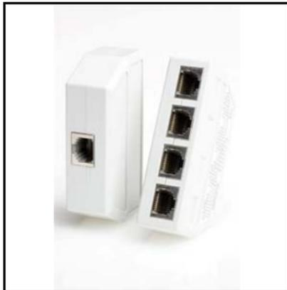
Quadrupleur qui copie toutes les broches d'un RJ45 femelle vers les mêmes broches de quatre RJ45 femelles. Peut être utilisé pour brancher en parallèle plusieurs applications haute-impédance. Ne pas utiliser pour des applications Ethernet, vidéo ou télévision.
