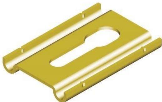
L'étrier pour treillis de plafond est fabriqué en tôle d'acier en zingage électrolytique selon NBN EN ISO 2081 et supplémentairement bichromatés. L'épaisseur de la couche de protection jaune varie entre 8 et 12  $\mu\text{m}$ . Les treillis de plafond Rejitech et Rejitech G+ sont montés au plafond au moyen de ces étriers spécifiques.
