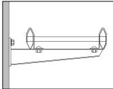
Montage d'une console 50 à l'aide d'un boulon en T.
