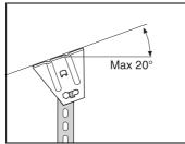
A l'aide de l'étrier de plafond 5 et d'un set de montage 22S, on obtient un pendard pouvant être incliné de 20° par rapport au plafond. Uniquement pour installation de supports consoles 3.
