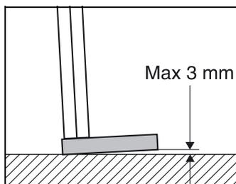
L'inclinaison maximale autorisée avant le serrage de la fixation est de 3 mm.
