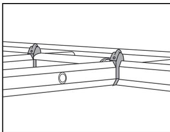
La crochet utilisé pour un changement de direction 90°. L'accouplement 22 peut aussi être utilisé pour des angles droits.
