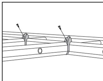
Un trou ø 5 mm est prévu pour la fixation sur le longeron à l'aide d'une vis parker ou un rivet.
