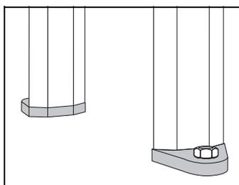
Le pied d'appui est fixé à l'aide d'un boulon d'expansion.
