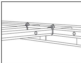
KHZSP, KHZSPZ, KHZPS, KHZ ou KHZP utilisée pour changement de direction horizontal 90° à partir de KHZV avec dérivation fixe crochet 4. Utilisez le profilé de protection 28P (couper sur mesure).
