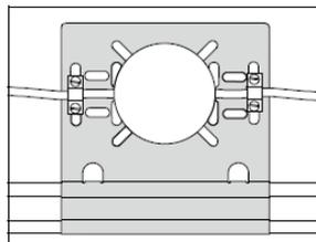
La plaquette peut être montée au dessus ou en dessous du longeron. Des arrêts de traction peuvent être obtenus à l'aide de clames ou rubans dans les trous extérieurs.
