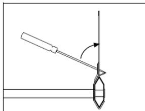
Pour fixer la plaquette, pliez la languette autour de l'échelon à l'aide d'un tournevis.
