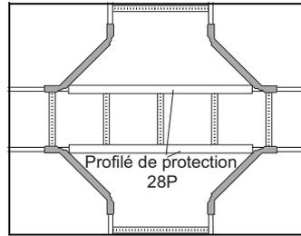
Utilisez quatre accouplements 14 pour réaliser un croisillon. Soutenir les échelles à accoupler à l'aide d'une console à proximité de l'accouplement. Utilisez du profilé de protection 28P (couper sur mesure).
