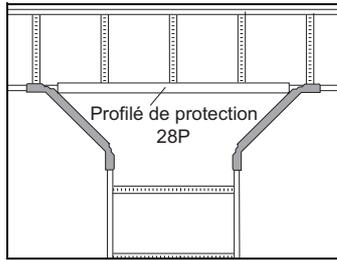
Utilisez deux accouplements 14 pour réaliser une pièce en T. Soutenir l'échelle à accoupler à l'aide d'une console à proximité de l'accouplement. Utilisez du profilé de protection 28P (couper sur mesure).
