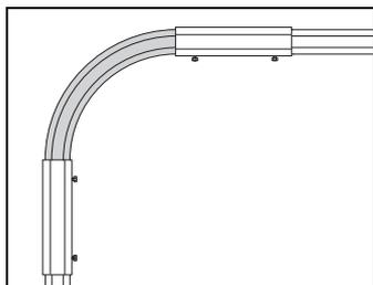
Les échelles à câbles doivent être accouplées à la pièce de montée à l'aide de l'accouplement 21.
