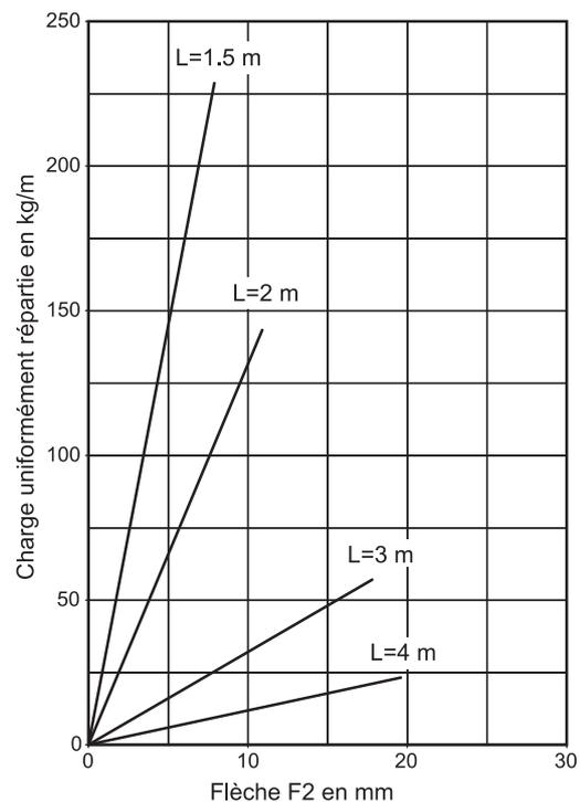
"Echelle à câbles KHZSP Tôle d'acier galvanisée Sendzimir L: 4000 mm
