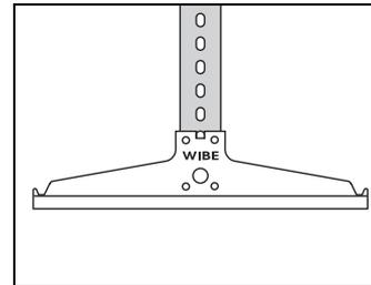
Le support console 3 est fixé à l'aide d'un set de montage 22S.
