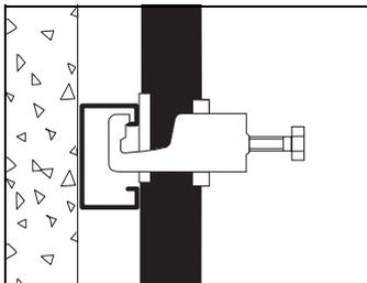
Les câbles sont fixés au profilé de suspension 24/48 à l'aide de pinces à câbles, type A.
