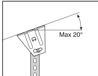
A l'aide de l'étrier de plafond 5 et d'un set de montage 22S, on obtient un pendent pouvant être incliné de 20° par rapport au plafond. Uniquement pour installation de supports consoles 3.
