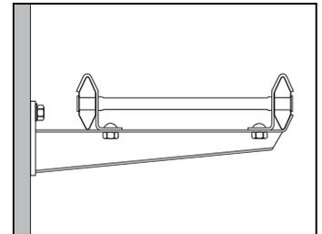
Montage d'une console 50 à l'aide d'un boulon en T.
