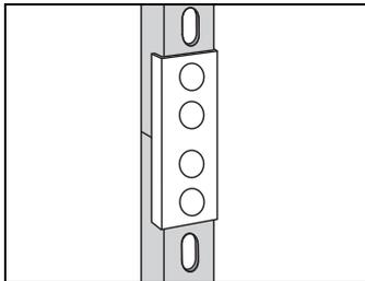
Le pendent 2F peut être rallongé à l'aide du profilé de suspension 24/48 et de l'éclisse d'assemblage 2FJ.
