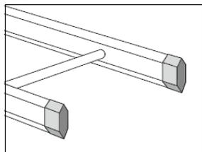
Monter des embouts de protection 28 dans les extrémités des échelles.
