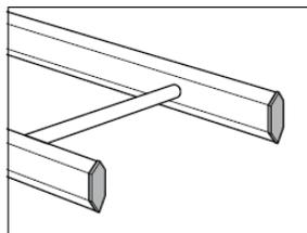
Montez des embouts de protection 28i dans les extrémités des échelles. Les échelles peuvent être accouplées à l'aide d'accouplements 21, les embouts de protection 28i étant insérés dans les échelles.
