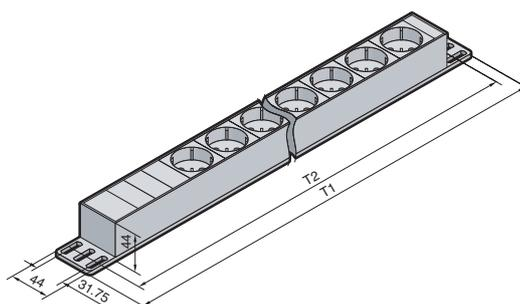
Les bandeaux de prises à boîtier aluminium sont disponibles en différentes longueurs et avec différents éléments fonctionnels. Leur système de fixation a été étudié pour un maximum de simplicité et de flexibilité : les équerres de fixation spéciales à quatre position de montage permettent par exemple, de monter un bandeau de prises de 482 mm de longueur soit sur les montants 482,6 mm (19"), soit sur l'ossature de l'armoire, soit encore à l'arrière d'un coffret mural.
