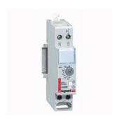
Minuterie modulaire électronique multifonctionnelle - alimentation 230 V - 50/60 Hz - contact 230 V - 16 A -1 module de 17,5 mm - réglage de 30 s à 12 min
