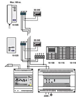
Cette alimentation en tension continue pour montage sur rail DIN convient pour des systèmes vidéo étendus. Elle est toujours utilisée en combinaison avec une alimentation 10-801 ou 10-802.
