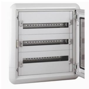
**Coffret de distribution XL<sup>3</sup> 160 complet encastré - 3 rangées - 72 modules - IP 40 - IK 08 avec porte - gris RAL 7035 - dim. (h x l x p) 695 x 670 x 100 mm**
