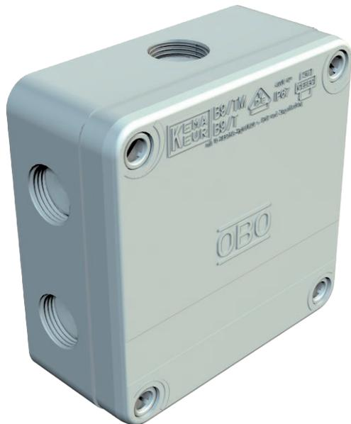
La boîte de jonction de câbles étanche à l'humidité B9 / T ...: se compose de deux composants en plastique sans halogène différents, avec une membrane perforée (pour des diamètres de câble jusqu'à 15 mm) dans la zone de base.
