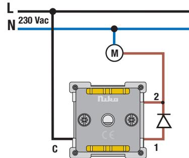
Mécanisme pour interrupteur rotatif pour moteurs 20 A à 3 vitesses, à savoir: 0-1-2 et 1-2-3, avec fixation par griffes. Un set de finition et une plaque de recouvrement d'une couleur au choix doivent être commandés séparément.
