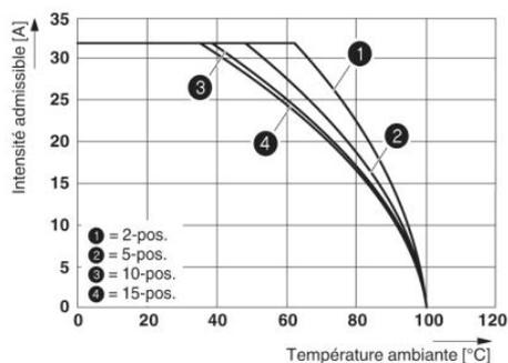
L'illustration montre une courbe de derating de la borne UT 4/ 1P... en liaison avec le connecteur UPVB 4
