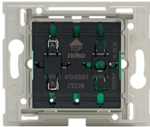
Mécanisme pour interrupteur sans fil à 2 boutons de commande. Cet interrupteur sans fil vous permet de commander de manière indépendante jusqu'à 2 circuits. Il peut être utilisé pour des fonctions à 1 ou 2 boutons. Il est fourni avec une pile. Un set de finition d'une couleur au choix doit être commandé séparément.
