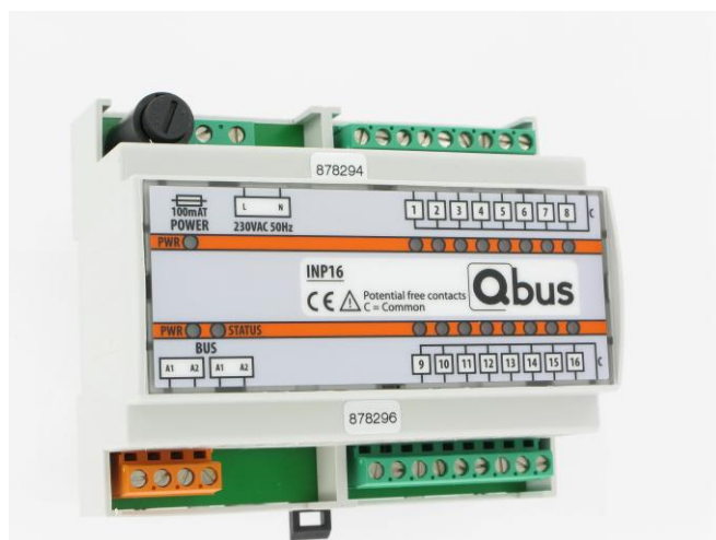
Figure 1 : module d'entrée INP016
