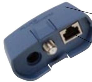
**Adaptateur de schéma de câblage**, qui fait aussi office de capuchon de protection
