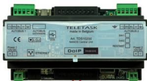
Unité centrale à montage sur rail DIN, équipée de 2 raccordements AUTOBUS. Elle peut être configurée via USB ou LAN(WAN) Ethernet. 2 x 31 interfaces au maximum peuvent être raccordées aux deux raccordements AUTOBUS disponibles standard. Au moyen d'une interface d'extension AUTOBUS, le nombre de raccordements AUTOBUS peut être étendu à 4. Ainsi, 124 interfaces au total peuvent être connectées à la centrale.
