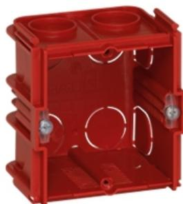
Batibox boîte d'encastrement carré associable (horizontal et vertical) - 1 poste - profondeur 60 mm - livré avec vis équipées de cache de protection
