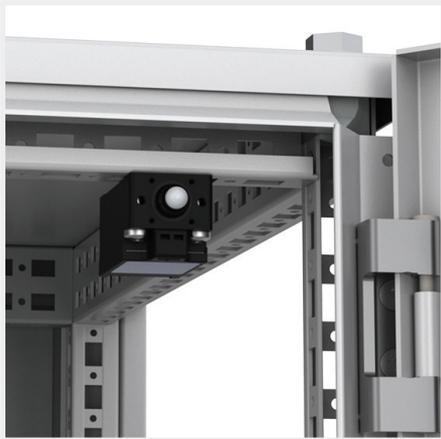
**Description:** Interrupteur de porte pour activer les appareils électriques (éclairage, signalisation, alarmes, etc.). Peut être installé après la pose de l'armoire de façon à garder la porte ouverte. Fixé sur les perforations internes du châssis de l'armoire pour les armoires au sol. Entrée de câble M20.
