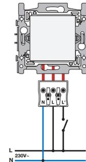
Mécanisme pour éclairage d'orientation avec LED blanches 830 lux, avec fixation par vis. L'éclairage d'orientation est pourvu d'une pile de secours qui se charge de l'alimentation pendant 15 minutes en cas de coupure de la tension. Une plaque de recouvrement d'une couleur au choix doit être commandée séparément.
