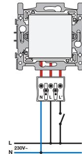
Mécanisme pour éclairage d'orientation avec LED blanches 830 lux, avec fixation par griffes. L'éclairage d'orientation est pourvu d'une pile de secours qui se charge de l'alimentation pendant 15 minutes en cas de coupure de la tension. Une plaque de recouvrement d'une couleur au choix doit être commandée séparément.
