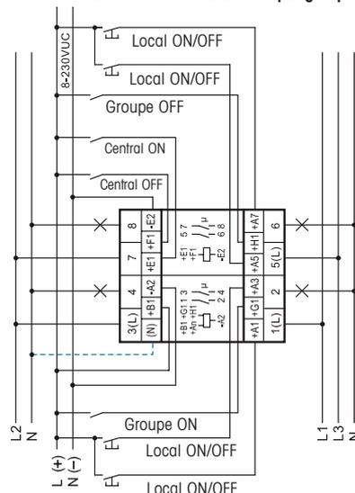
Lorsque le N est raccordé, la commutation en valeur de phase zéro est activée par les contacts 1-2, 3-4 et 5-6.
