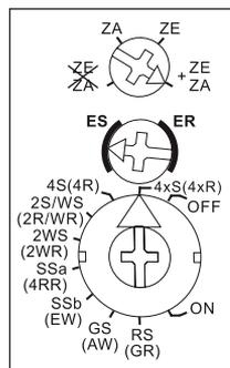
**Le commutateur rotatif supérieur** permet de découpler ce télerupteur-relais complètement ou partiellement de la commande centralisée :
