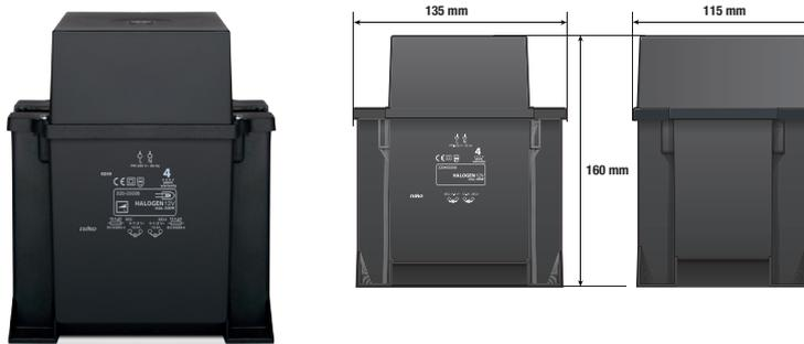
Ce bloc transformateur ferromagnétique a une puissance de 300 W. Il convient au raccordement de lampes basse tension (LED 12 V). Vous pouvez ensuite faire varier l'intensité lumineuse de ces lampes au moyen de contrôle de phase et de variateurs universels. Le transformateur se raccorde au moyen de deux bornes à vis du côté primaire et de quatre bornes à vis du côté secondaire. Il possède un degré de protection IP20. Les pieds de fixation sont fournis.
