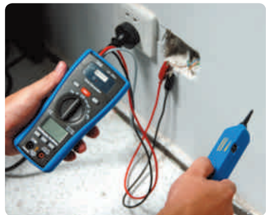
Tester sans assistance le câblage dans l'armoire en connectant simplement les pincettes crocodile aux gaines aux prises de contact.
