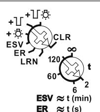
**L'interrupteur rotatif supérieur**, dans la position LRN, permet de programmer jusqu'à 35 émetteurs radio bouton-poussoir, donc un ou plusieurs boutons-poussoirs pour commande centralisée. Également des contacts porte/fenêtre avec la fonction NO ou NF en cas de fenêtre ouverte, des détecteurs radio de luminosité pour montage extérieur FAH et détecteur radio de mouvement FBH. Ensuite il permet de sélectionner la fonction désirée du télérupteur-relais de couplage :
