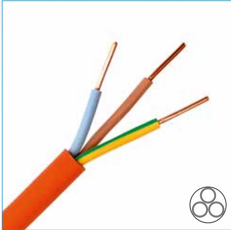
Câble résistant au feu garantissant le maintien de fonction, utilisé pour les installations de sécurité et les installations critiques qui, pour des raisons de sécurité, doivent rester en service pendant un certain temps : installations de détection, d'annonce, d'alerte, d'alarme, de déverrouillage des portes, d'évacuation des fumées, ascenseurs avec appel prioritaire, d'éclairage de sécurité, d'éclairage de secours ...
