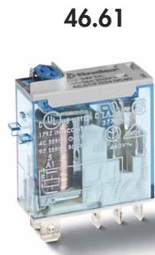
• 1 inverseur, 16 A • Faston 187 (4.8x0.5 mm)
